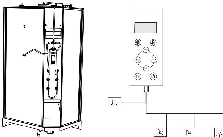
10. Установите кабину согласно схеме подводки воды и электричества.
