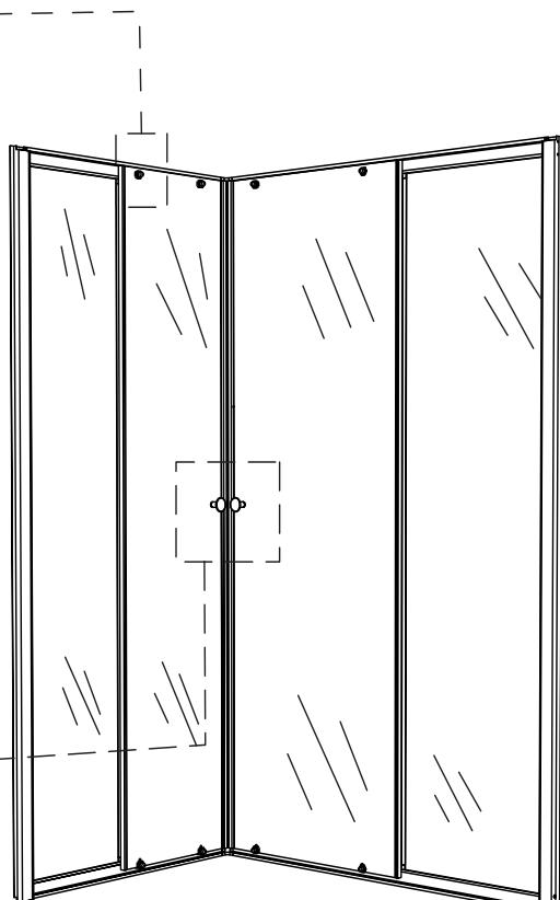
5. Установите на поддон задние стенки. Вставьте и закрепите согласно схеме выход шланга ручной лейки и внутренний держатель ручной лейки
