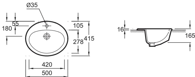
Спецификация продукта: Раковина 50 x 41,5 см. E1358. Коллекция: OVALE DESSUS. Размеры (см): 50 x 41,5 см. Вес: 8,3 кг. Разметка сверления отверстия для смесителя: Одно сквозное отверстие, два размечено.
