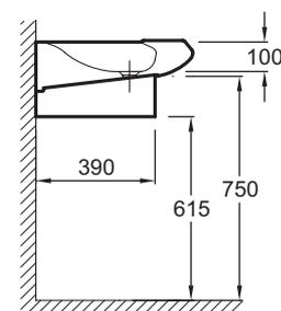
Спецификация продукта: Раковина-столешница 120 x 52 см без отверстия для ручки донного клапана. E1292-09. Коллекция: STILLNESS. Размеры (см): 120 x 52 см. Вес: 32 кг. Разметка сверления отверстия для смесителя: 1 отверстие для смесителя 35 мм. В комплекте: Ручка донного клапана. Рекомендуется: Декоративный слив с регулируемой высотой E78291. Рекомендуемые смесители: однорычажный смеситель Stillness E985-4.
