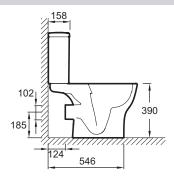
Спецификация продукта: Унитаз напольный без обода. UJX102. Коллекция: STRUKTURA. PA3MEPЫ (СМ): 64,50 х 34 см. ВЕС: 36,6 кг. ТИП УСТАНОВКИ: Напольные. РАСХОД ВОДЫ: 2,6/4 л и 3/6 л. ВЫСОТА: Стандартные. ТИП ОБОДА: Без обода. ОБОД: Стандарт. ПРОДУКТ В КОМПЛЕКТЕ: (бачок и крышка-сиденье заказываются отдельно). БЕСШУМНЫЙ ВПУСКНОЙ МЕХАНИЗМ: Класс тишины 1. КРЫШКА-СИДЕНЬЕ: Не входит в комплект. ГАРАНТИЯ НА КЕРАМИКУ: 25 лет. ГАРАНТИЯ НА МЕХАНИЗМ: 2 года. УПАКОВКА: Единая упаковка.
