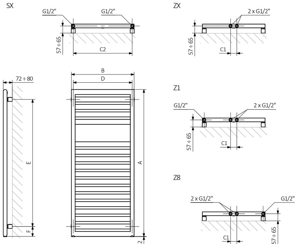
A – высота B – ширина C1-C5 – расстояние между осями подключения D – расстояние между осями крепежей по горизонтали E – расстояние между осями крепежей по вертикали F – расстояние от оси нижнего крепежа до нижнего края коллектора
