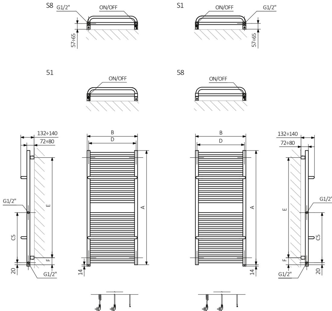
A – высота B – ширина C1-C5 – расстояние между осями подключения D – расстояние между осями крепежей по горизонтали E – расстояние между осями крепежей по вертикали F – расстояние от оси нижнего крепежа до нижнего края коллектора
